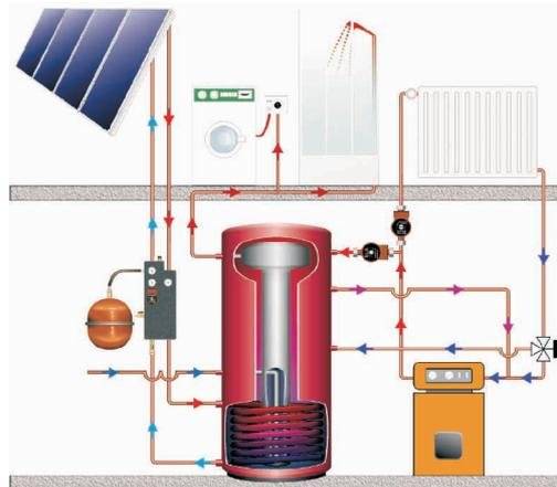
Bild 7: Solaranlage zur Heizungsunterstützung und Trinkwassererwärmung mit Kombispeicher und Rücklaufanhebung des Heizkreises
