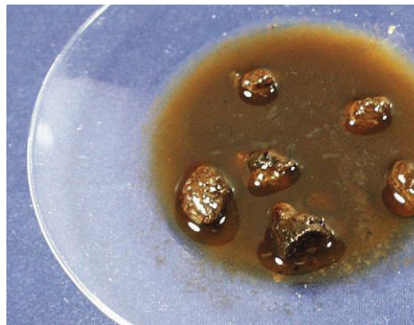
Zerstörtes Solarfluid mit unlöslichen Zersetzungsprodukten
